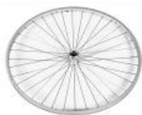
Tylne koło, konstrukcja, 36 szprych, proste szprychy
